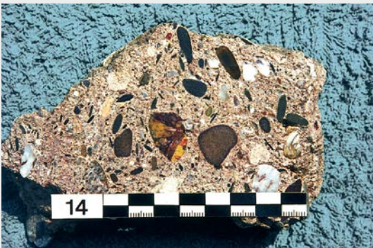
Bild 16: Römischer Beton aus dem Gewölbe des Trierer Amphitheaters aus dem 2. Jahrhundert
